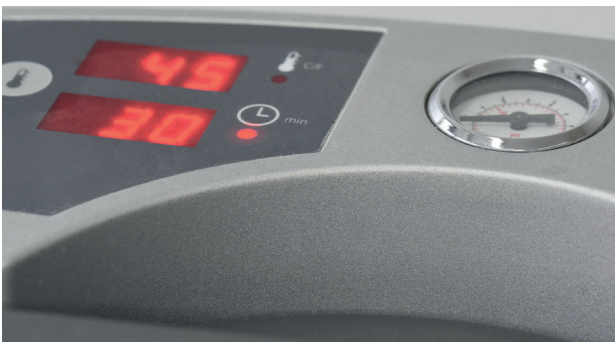
18. Bei 45 °C 15 Minuten bei 3 bar polymerisieren
